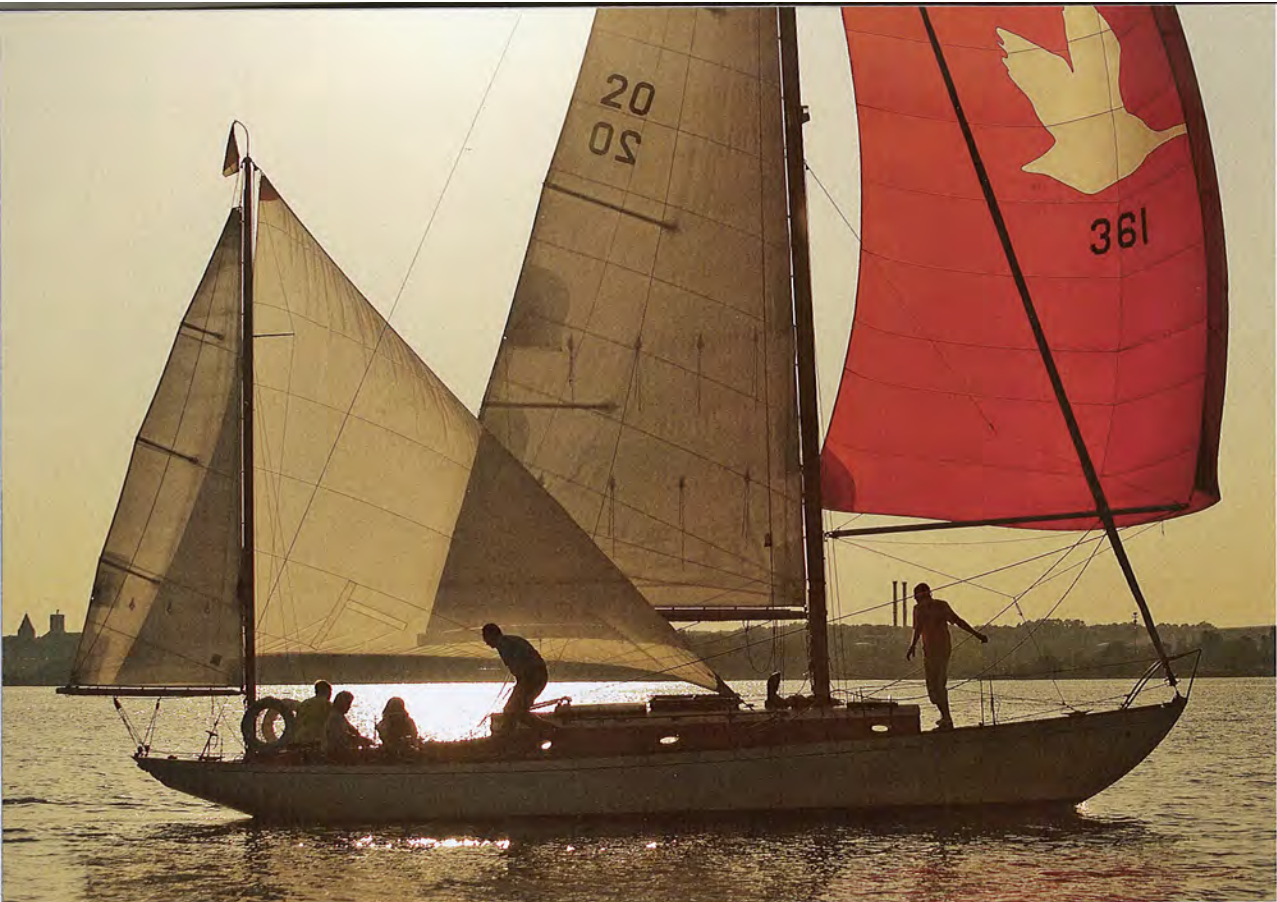
Garderobe. Das in Serie gefertigte Holzboot wurde als einhanttauglicher Daysailer geordert. Der Konstrukteur verteilte die Segel für eine bessere Bedienung. Die langen Überhänge sind ebenfalls recht typisch für den Bootsbau der vierziger Jahre
