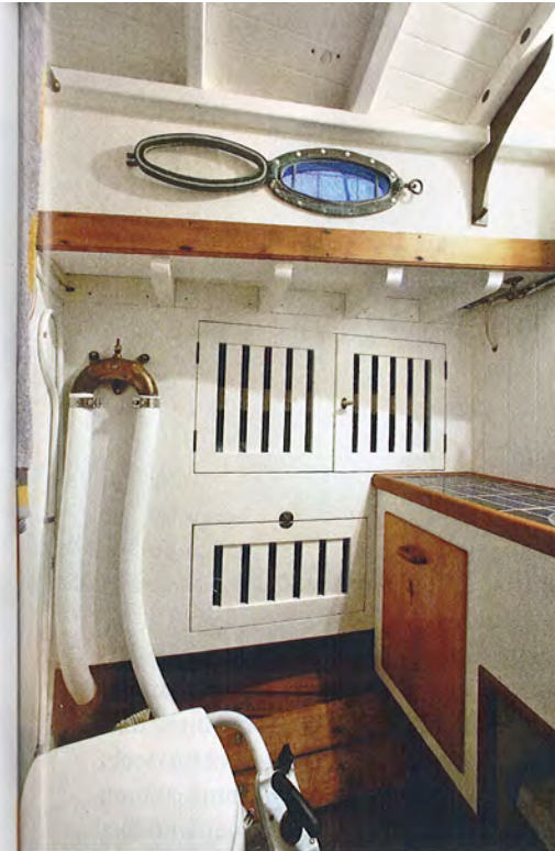
Wohlfühlklima. Archaische Klappfenster im Aufbau und große Lüftungsschlitze in den Schapps, ein gasbetriebener Ofen mit Herdplatte und Wegerungen im Vorschiff sorgen für Trockenheit und Wärme. Das Typenschild ist seltener Beleg für die Endphase im Serien-Holzbootbau
